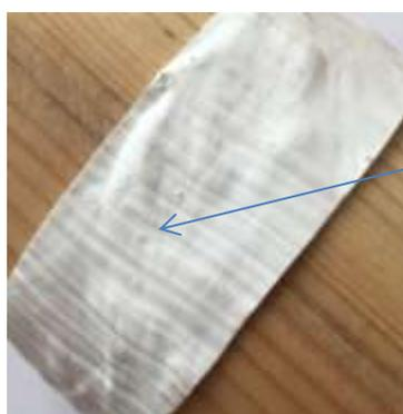
Трещина лакокрасочного покрытия
