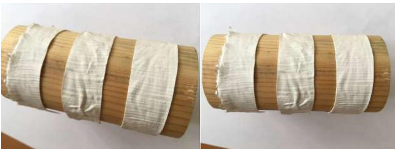
Фото 3. Испытание образцов краски на брус  $R=25$  мм при  $T= - 45$  °С
